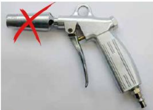
Figura 2: l'uso di pistole ad aria compressa con ugelli Venturi non è consentito.
